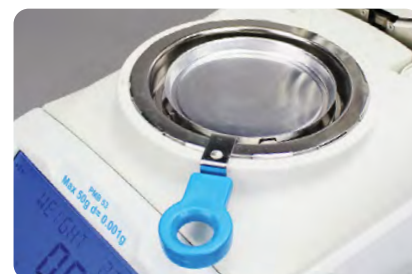
La poignée du plateau permet de placer l'échantillon et de le retirer facilement
