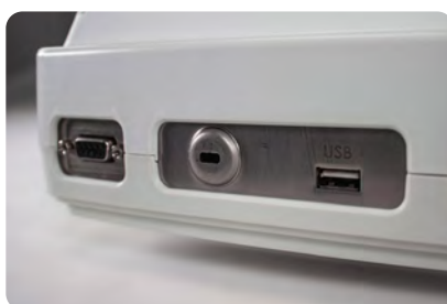
Interface RS-232/USB pour la connexion aux ordinateurs et aux imprimantes avec les ordinateurs et les imprimant
