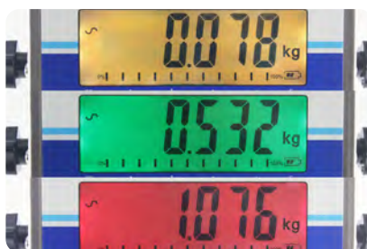
L'écran rétroéclairé change de couleur pour une notification des limites de contrôle de poids
