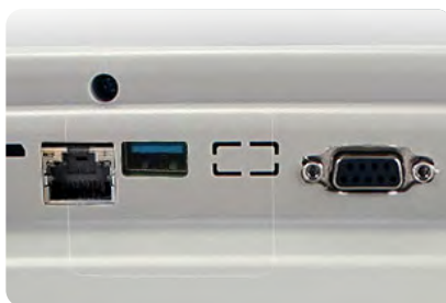
Interface RS-232 et USB (Bluetooth, RJ45 et WiFi optionnel)
