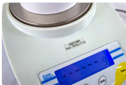
La fonction ShockProtect® à trois points aide à protéger les composants internes lors d'une surcharge
