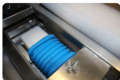
Cellule de pesée étanche, encapsulée et revêtue de silicone
