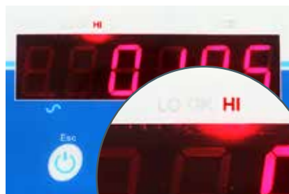
Affichage de la fonction contrôle de pesée par trois couleurs LED lumineuses
