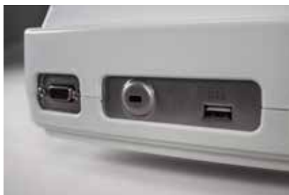
Interface RS-232/USB pour la connexion aux ordinateurs et aux imprimantes avec les ordinateurs et les imprimantes
