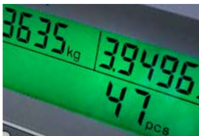
Poids unitaire, poids total et pièce comptés clairement visible en un seul endroit
