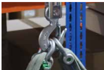
Le crochet rotatif permet un accès facile pendant le chargement, puis se verrouille en toute sécurité pendant le pesage.
