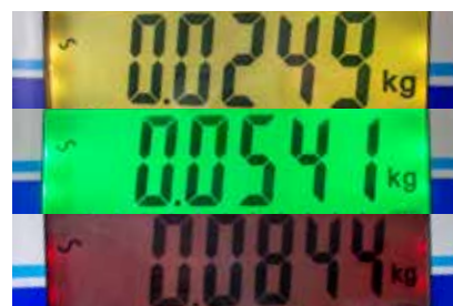
L'écran rétroéclairé change de couleur pour une notification rapide des limites de contrôle de poids
