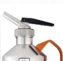
**Fermeture automatique (doseur et robinet):** s'ouvre uniquement pendant le fonctionnement. Se ferme automatiquement par la force du ressort après l'utilisation ou en cas de chute accidentelle (par exemple en cas d'urgence). Cela évite la contamination et les dangers dus à un déversement incontrôlé ainsi que la propagation du feu. De même, la libération éventuelle de vapeurs nocives ou inflammables sont évitées.
